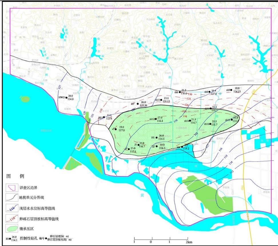
图 3.1-5 调查区内松散岩类孔隙水潜水—微承压水分布图
