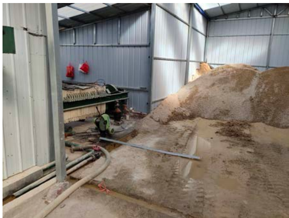
精矿、次品料控水区地面导流渠
