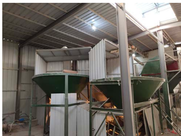
磨粉设备进料处设置集气罩
