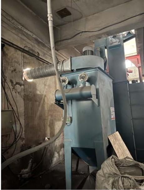
喷砂机配套除尘器
