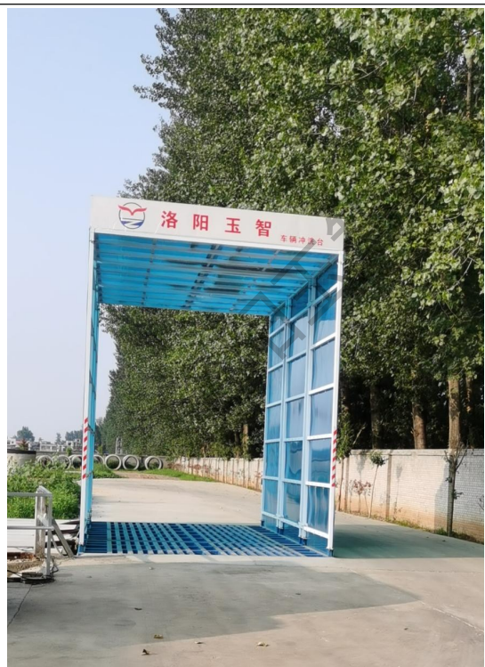
车辆冲洗装置
