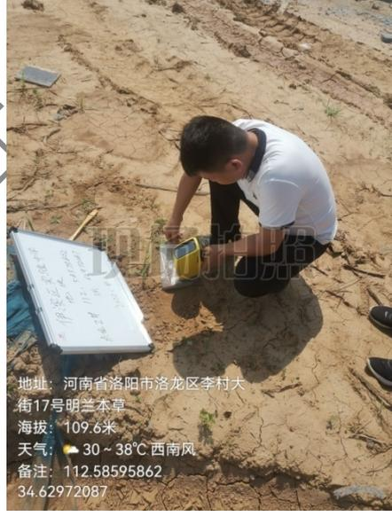
图 3-5 土壤快检采样照片 (2#点位)
