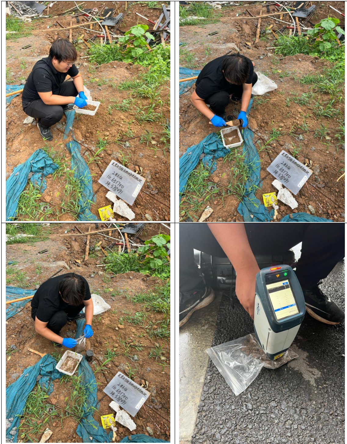
图3-4 土壤快检采样照片（2#点位）
