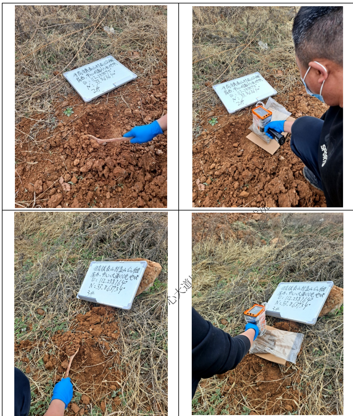
图 3-5 土壤快检采样照片
