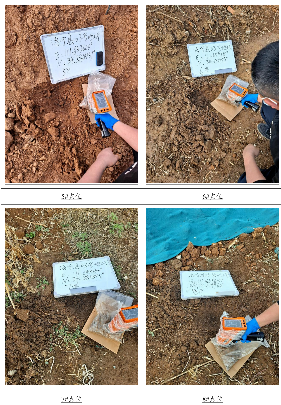
图 3-5 土壤快检采样照片
