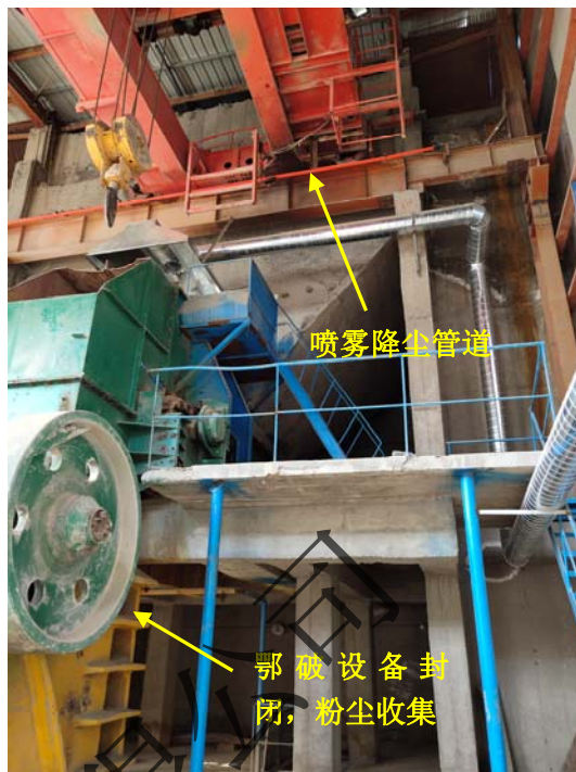
颚式破碎机设备封闭，设置收尘管道 鄂破设备上方设置喷雾降尘管道
