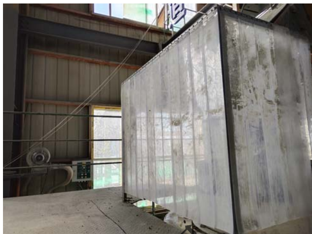
中、细碎圆锥破碎机设置集气罩，集气罩四周设置软帘封闭，进一步提高收集效果
