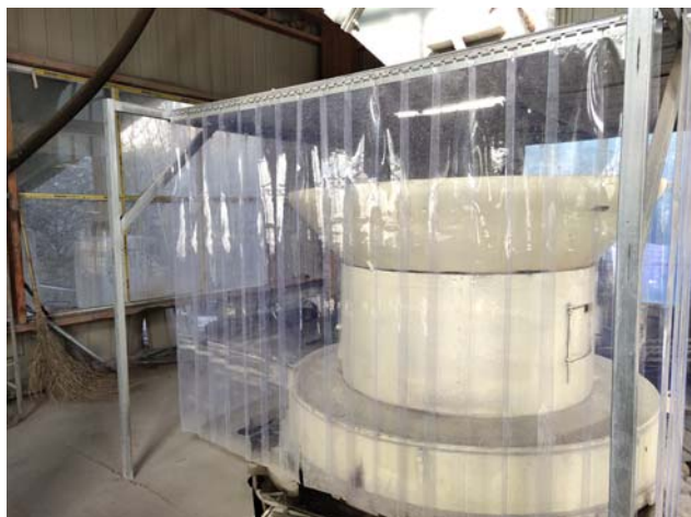
中、细碎圆锥破碎机设置集气罩，集气罩四周设置软帘封闭，进一步提高收集效果
