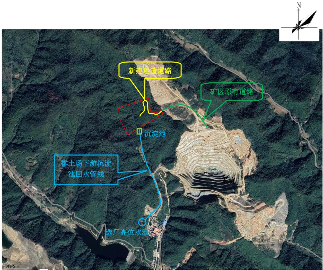
附图四 排土场淋溶水回水管线及废石运输道路路线图
