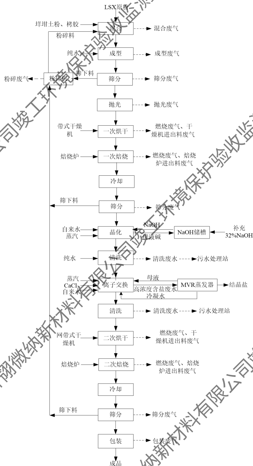
图 3-6 低硅钙 X (CaLSX) 分子筛工艺流程及产污节点图
