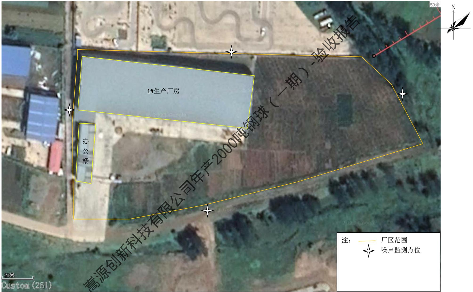
附图三 厂区平面布置图及监测点位示意图
