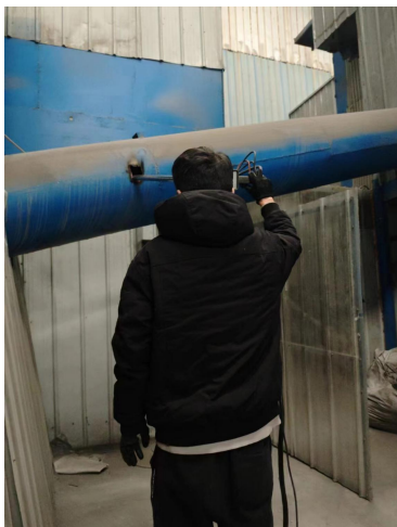
有组织废气现场检测照片
