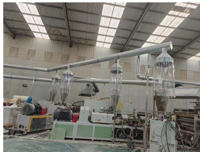
挤出机进料仓上部设置集气罩
