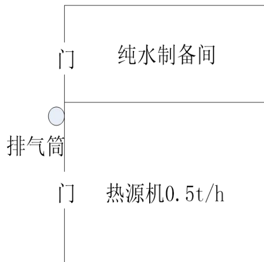
生活区蒸汽热源机 平面布置图
