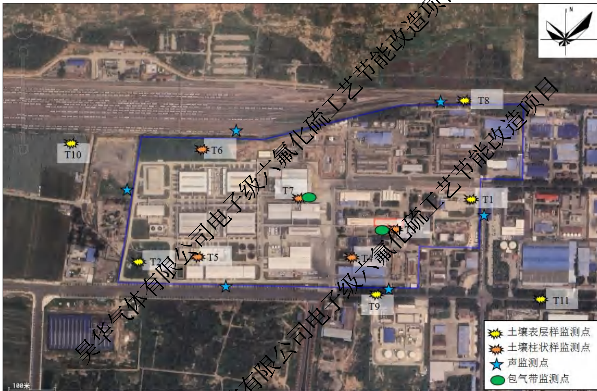
附图七：项目监测点位图（土壤、声、包气带）
