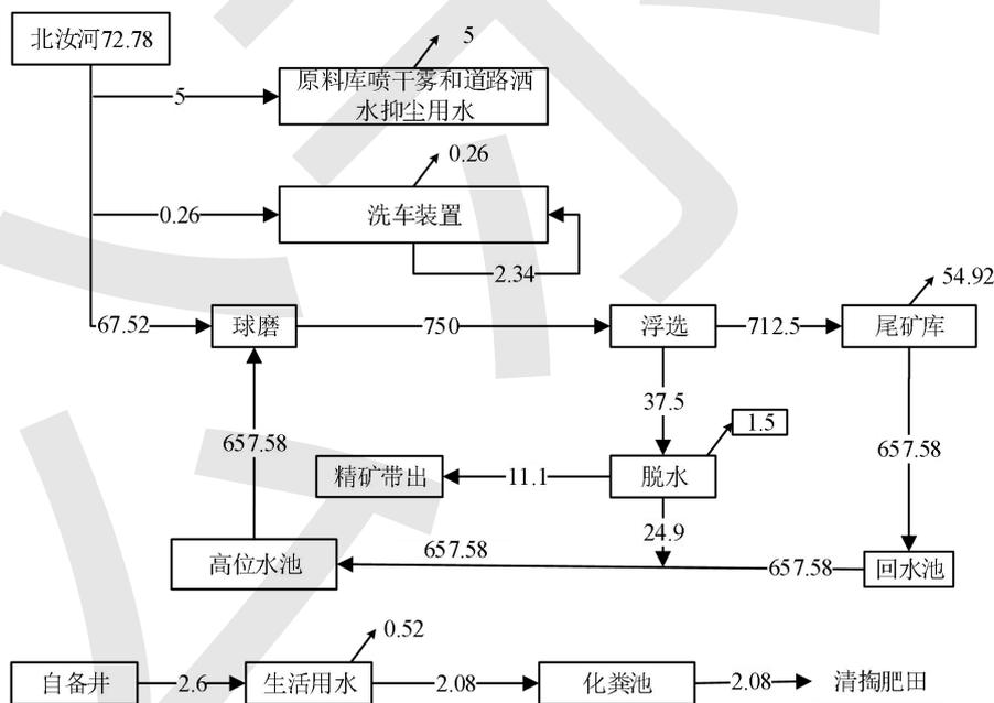
图 2-2 验收时水平衡图 (单位: m³/d)
