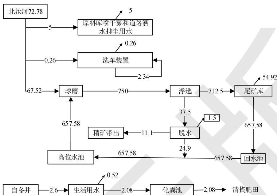
图 2-1 环评时水平衡图 (单位: m³/d)
